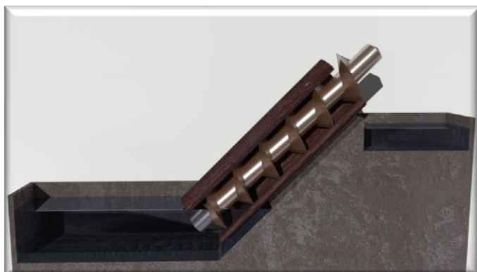
Abb. 1: Schraube des Archimedes. Durch kontinuierliche Rotation der Schraube wird Wasser vom unteren in das obere Reservoir gepumpt. (Grafik: MPQ, Abt. Quanten-Vielteilchensysteme)
